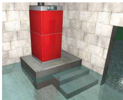
Réhausse permanente d'un équipement de chauffage
